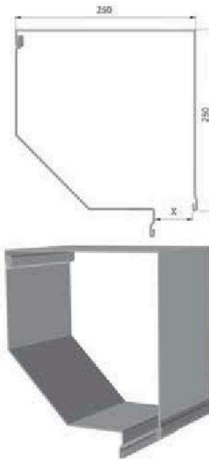
SLR/RR caisson alu plié 45° 250 mm
